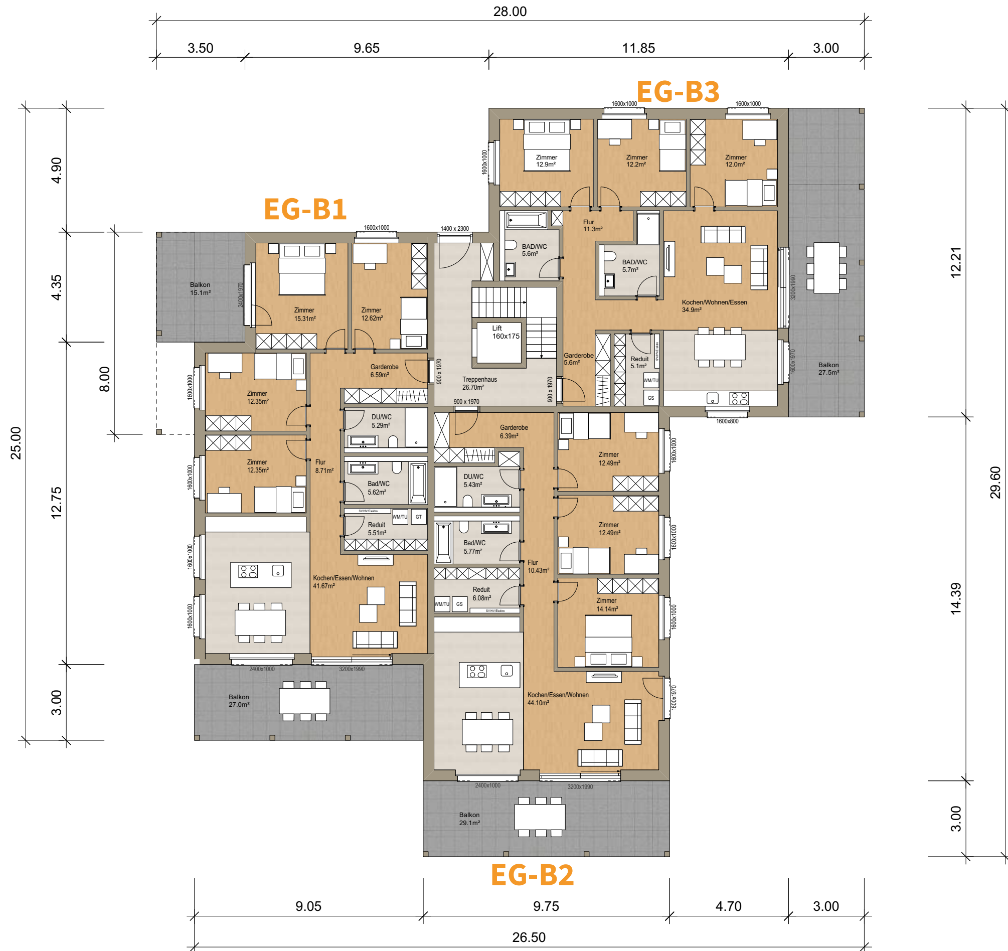
Grundriss Erdgeschoss MST:1:150
